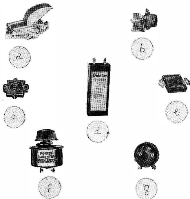
Fig. 66 : Elementos y componentes de la época comprendida entre los años 1920 a 1930: a) capacitor variable "Pilot" de bronce tipo "Capacigrad" de 0,0005 \mu\text{F} , 23 placas; b) compensador variable "Pilot" de 35 pF, 11 placas; c) capacitor fijo de mica moldeado "Pilot" de 0,006 \mu\text{F} "Isograd" 400 V aislación. Estos elementos son de 1923/25; d) capacitor fijo de papel "Dubilier" tipo 901 de 1 \mu\text{F} y aislación 400 V (1920); e) capacitor fijo de mica moldeado "Aerovox" de 0,01 \mu\text{F} y 400 V aislación (1930); f) reóstrato de alambre de 3 W "Pilot" (1923).
